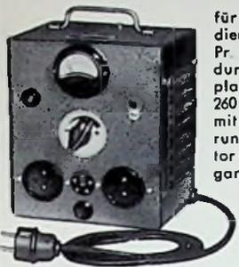
für Werkstatt und Kundendienst, Leistung: 300 VA, Pr. 110/125/150/220/240 V durch Schalter an d. Frontplatte umstellbar, Sek. 180-260 V in 15 Stufen regelbar mit Glühlampe und Sicherung. Dieser Transformator schaltet beim Regelvorgang nicht ab, daher keine Beschädigung d. Fernsehgerätes.
